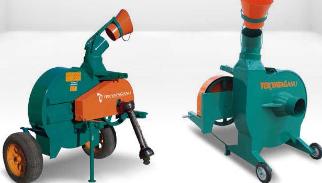
Üç nokta askı sistemi ile traktöre bağlanan saman aspiratörü hareketini traktör kuyruk milinden almaktadır. Samanı bir yerden başka bir yere nakil yapar. Yüksek devirli körük sistemi ile oluşan hava sirkülasyonu sayesinde de samanı uçma şeklinde taşır. Traktörün hidrolik koluna bağlanarak veya makinanın arka tarafında bulunan çeki oku vasıtısıyla traktörün veya römorkun çekisine bağlanarak veya makina taşıma işlemi yapar.
